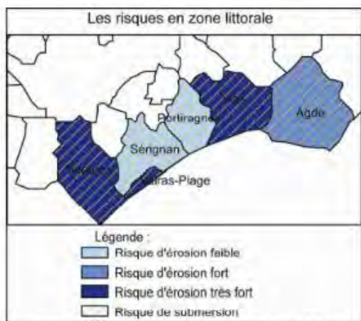
Risque d'érosion littorale (Source : DDRM 34)
